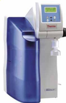
I sistemi MicroPure sono forniti per uso immediato con: riduttore di pressione, filtro finale, cartuccia dell'acqua ultrapura
