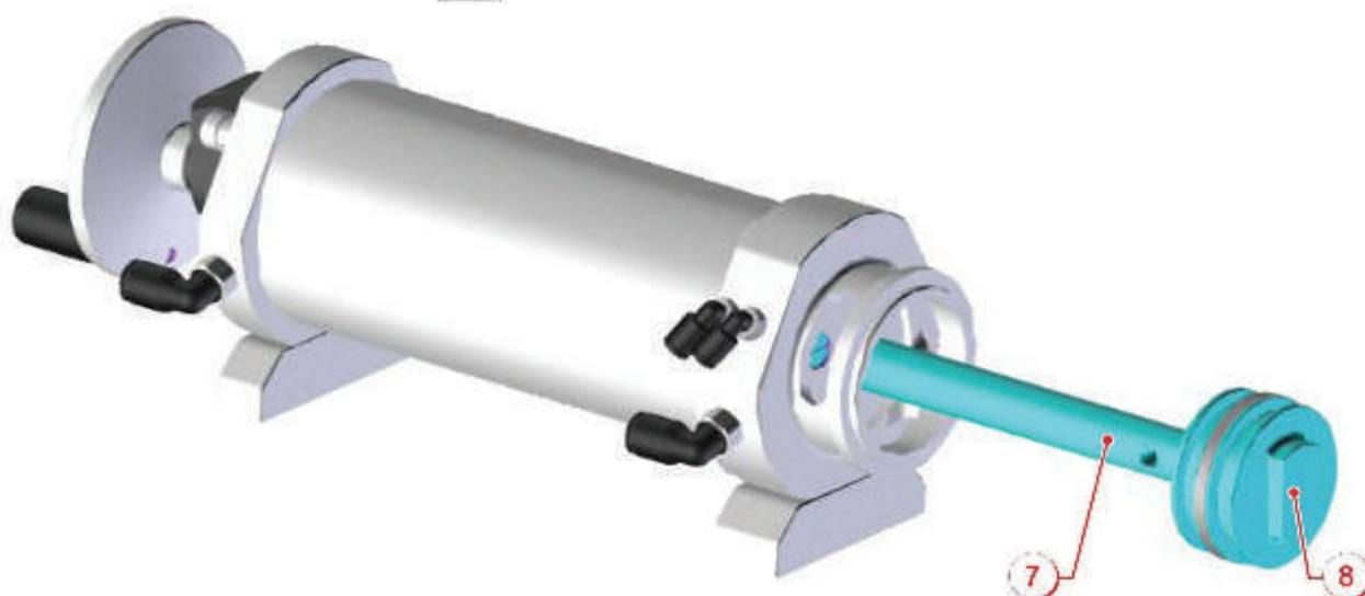
5. Lo stelo **7** è dotato di un foro, questo permette all'operatore di tenerlo fisso, con l'ausilio di una chiave speciale (fornita con la macchina), mentre attraverso una chiave fissa si svita la testa del pistone **8**.
