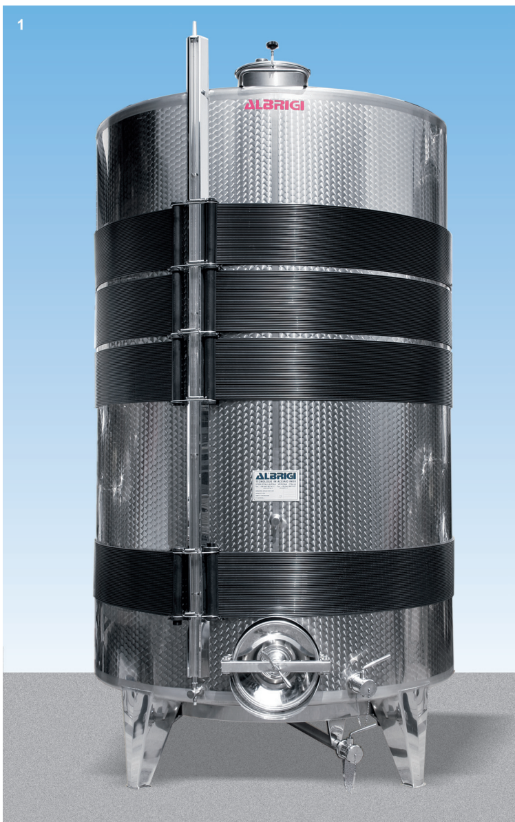
I Serbatoio da hl. 100 con doppio sistema di riscaldamento in basso e raffreddamento in alto a 3 fasce.
