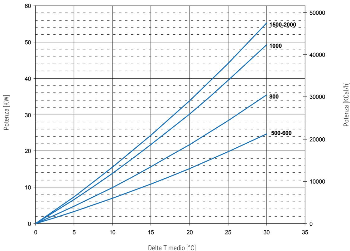
Le curve del grafico indicano la potenza degli scambiatori per TERMOACCUMULATORI PUFFER 2 in funzione del DeltaT medio fra primario ed accumulo con portata primario di 3 m<sup>3</sup>/h.
