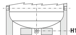
Il bollitore è dotato di una pratica **"gonna"** di appoggio che ne rende possibile la movimentazione con transpallet e muletti e **scarico totale** con tubazione già montata.
