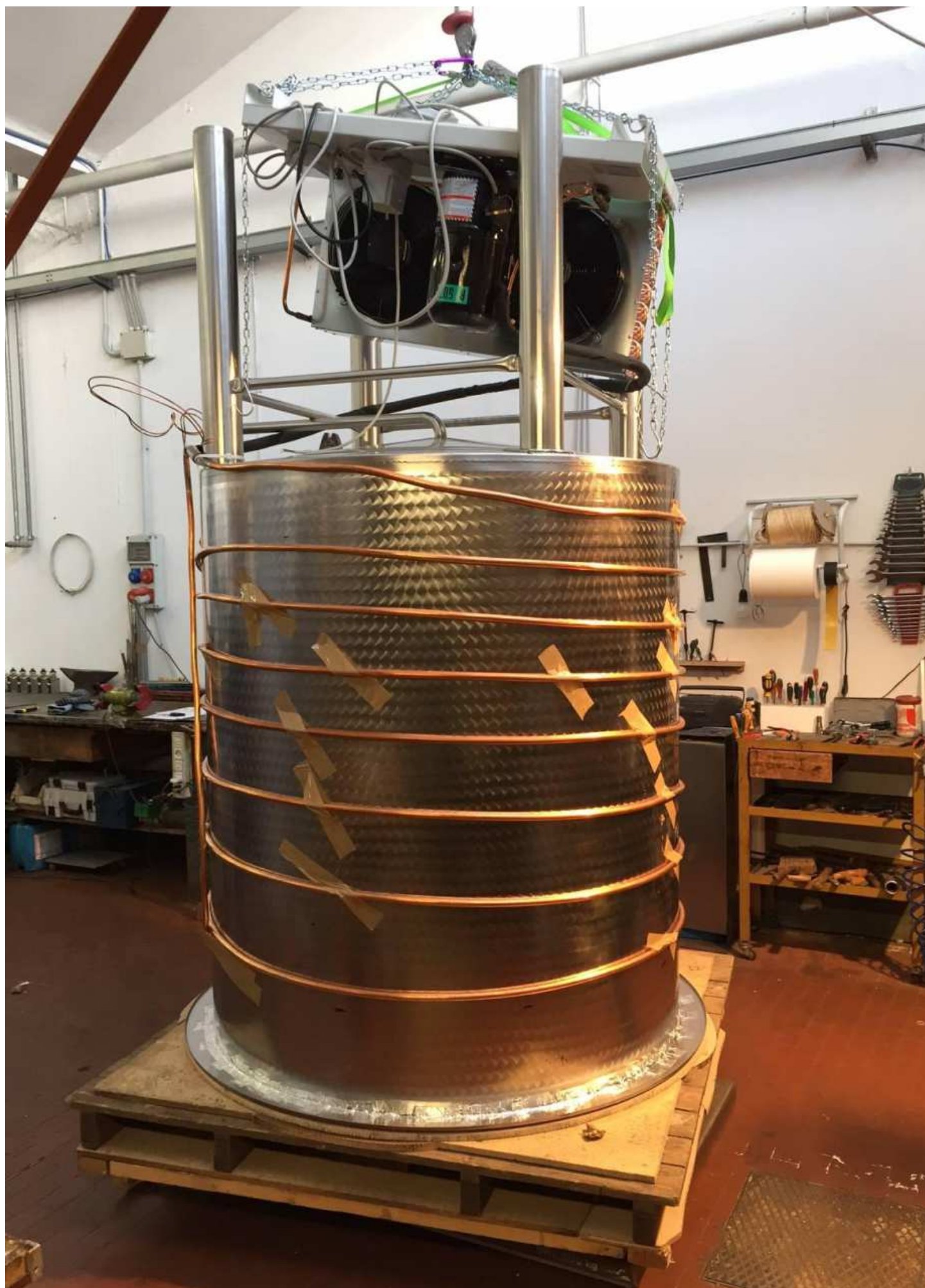
FASE DI MONTAGGIO DI UN SERBATOIO A FONDO CONICO 10°
