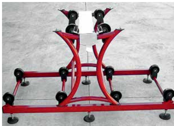
Slitta per inserimento barriques - Insert slide tool
